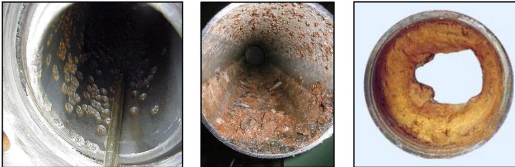
**Fig. (B8): La corrosión, el desgaste y las incrustaciones en tuberías disminuyen la eficiencia de flujo.**
