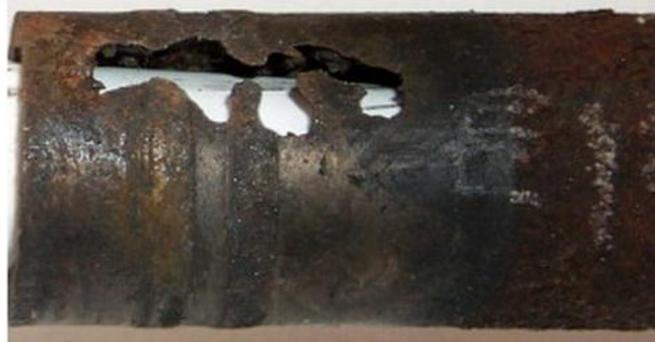
**Fig. D3: Erosión por alta velocidad del gas y presencia de sólidos en la corriente de fluidos**
