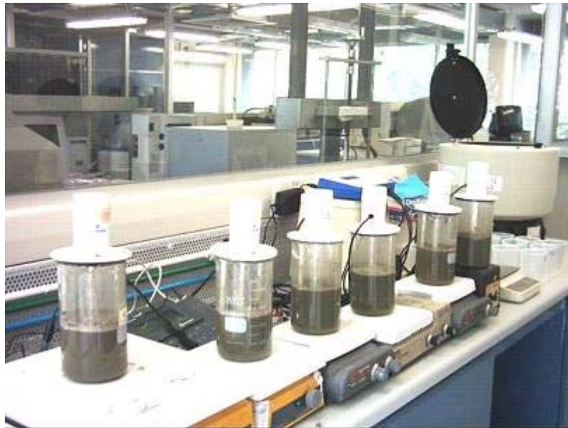
Figura 2.3 Prueba de desinfección de lodo fisicoquímico en un equipo de prueba de jarras
