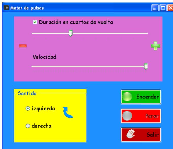
*Figura 23 Ventana para el control de un motor de pulsos.*
