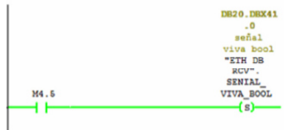
Figura 3.26.- El bit M4.5 se usa en esta línea para activar (set) la señal Booleana "Señal viva"
