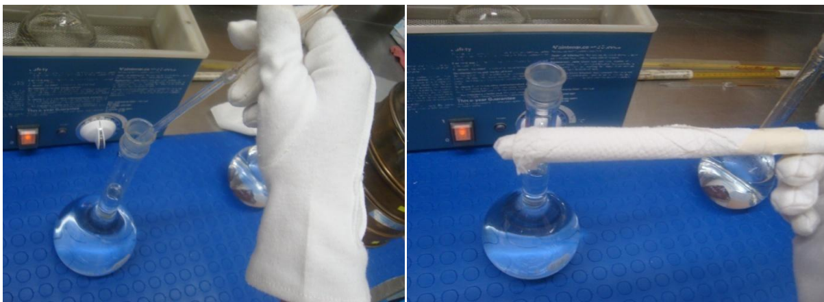
Figura 3.14 Utilización de guantes para evitar cualquier rastro de grasa durante la manipulación de las pruebas aforo de matraz y secado de las paredes del mismo para ser pesado
