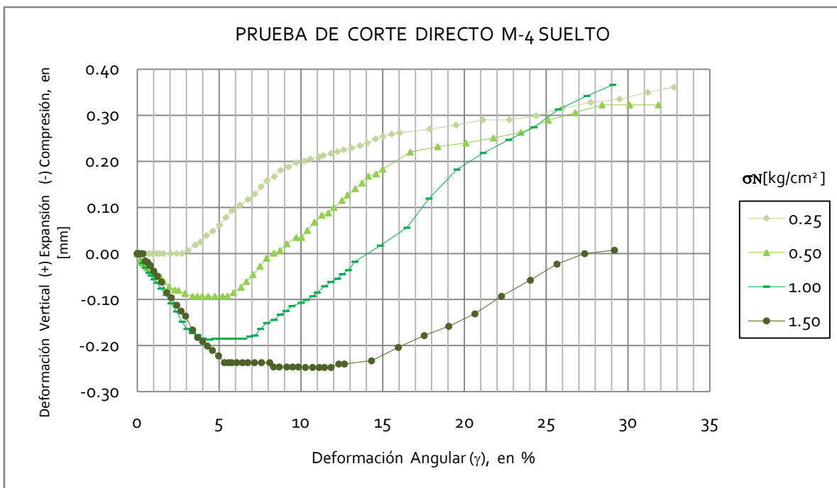
Figura 6.12 Curva Deformación Angular, Deformación Vertical (Expansión y Compresión) de la muestra M-4 Estado Suelto
