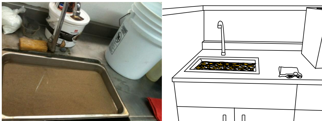
Figura 3.19 Lavado del material con abundante agua
