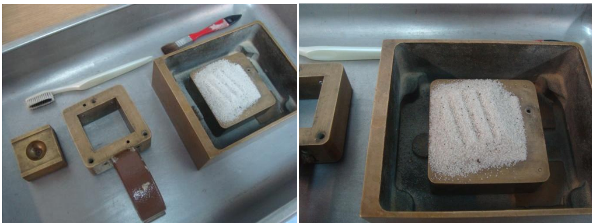
Figura 4.11 Limpieza en la caja de corte con alguna brocha y cepillo, para recuperar el material de la muestra, limpiando al fondo la placa porosa.
