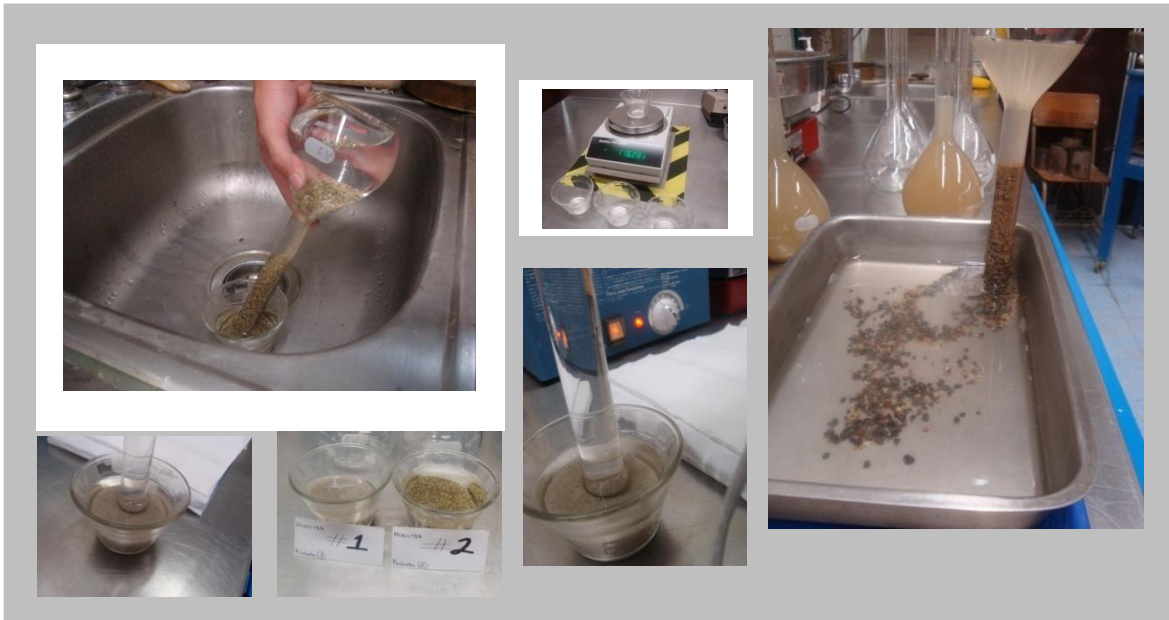
Vaciado de material en cápsulas o charolas después de los datos obtenidos para densidad de sólidos
