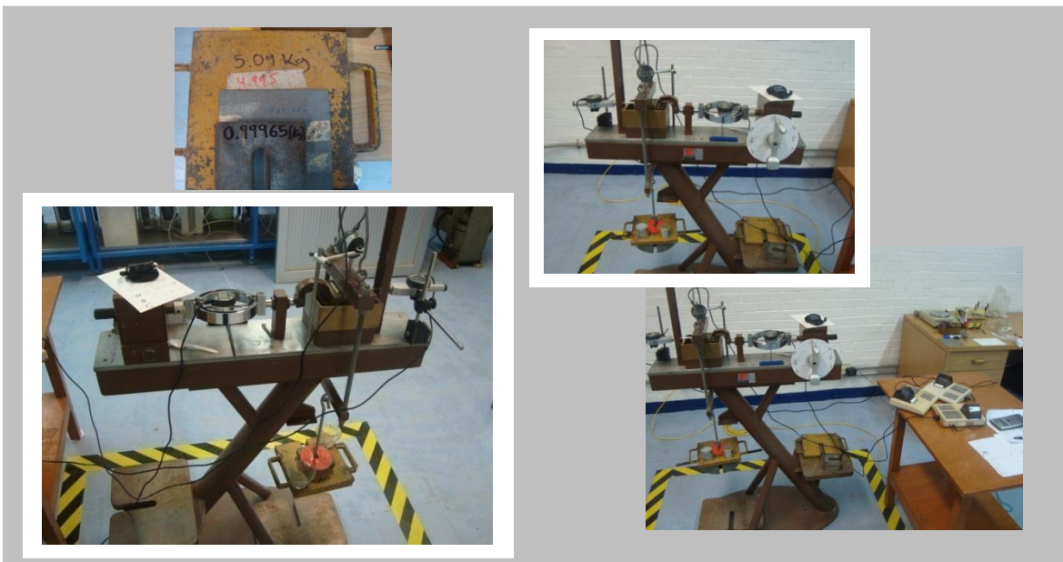
Colocación de las pesas para la Carga Vertical o Normal aplicada a la Caja de Corte como parte final de tener todo listo para los ensayos de cada material
