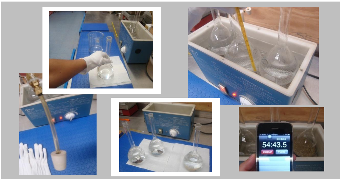
Matraces en baño maría en proceso de ser desaireados
