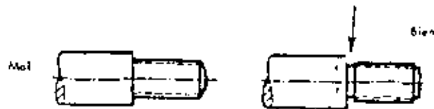
Figs. 65 y 66: Salida de la herramienta en el tallado de roscas
