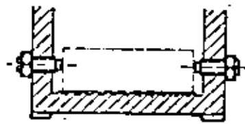
Fig. 199: Colocación de la pieza entre tornillos regulables
