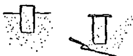
MUESTRA INALTERADA ENTUBADA EN ARENA
