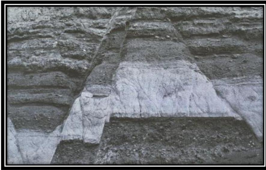
Figura 2.3 Fracturas de cizalla conjugadas en afloramientos dislocados por fallas normales
