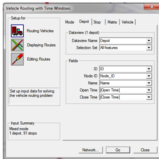
Figura 3.11. Pestaña Depot dentro del módulo para resolver el VRPTW en TransCAD
