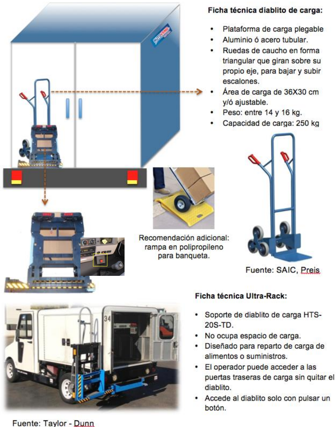
Figura 4.20. Propuesta en detalle de soporte en puerta de camioneta para diablito de carga. Incluye propuesta de diablito de carga.
