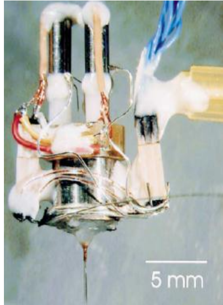
Figura 9. Microdrive con motores DC. Vista lateral del Microdrive completo cargado con electrodos y listo para su implantación. Una capa de acrílico se aplica a la parte inferior de la unidad para fijar el Microdrive en el cráneo [11].
