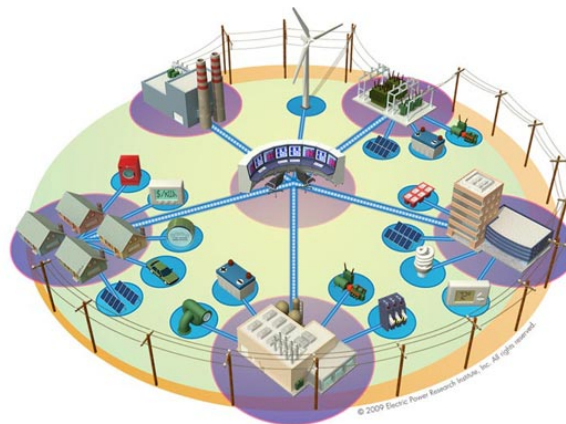
Figura 1.4: Esquema típico de una Microrred
