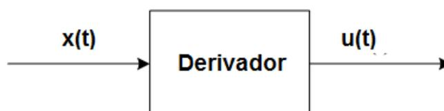
Figura 2.1: Relación entre la entrada del derivador y su salida
