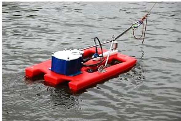
Fotografía 6.10. Perfilador vertical de efecto doppler móvil.
