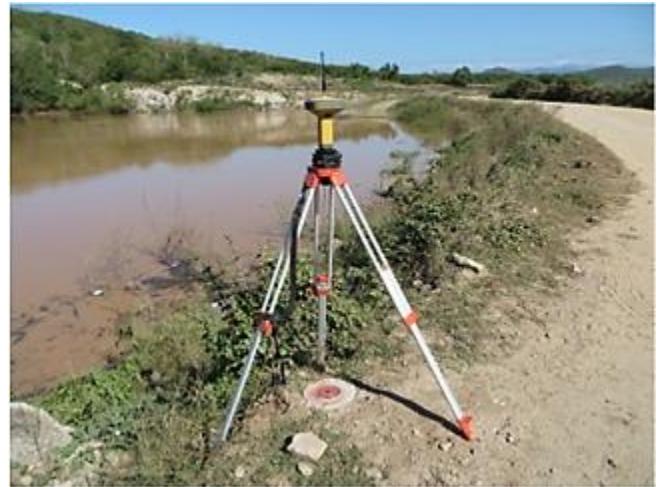
Estación base del equipo RTK
