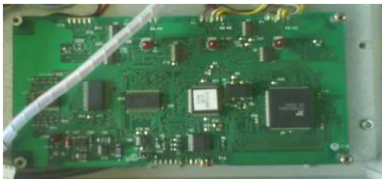
Figura 4.5 Tarjeta de conmutación
