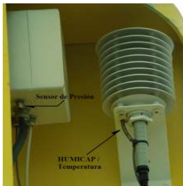
Figura 2.4 Humedad, presión y temperatura
