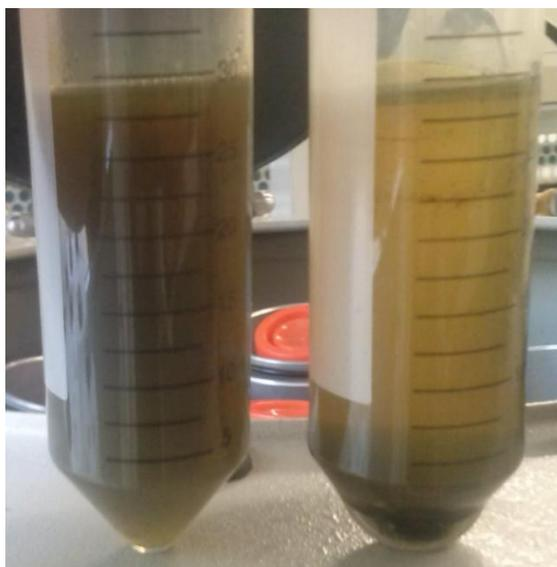
Figura 28 - Viales de polipropileno con extractos diluídos antes y después de centrifugar
