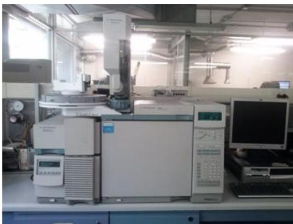
Figura 14 - Cromatógrafo de gases acoplado a espectrómetro de masas
