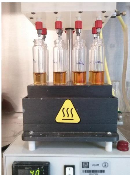
Figura 13 - Evaporación de fases orgánicas con  $N_2$  de ultra alta pureza y calor
