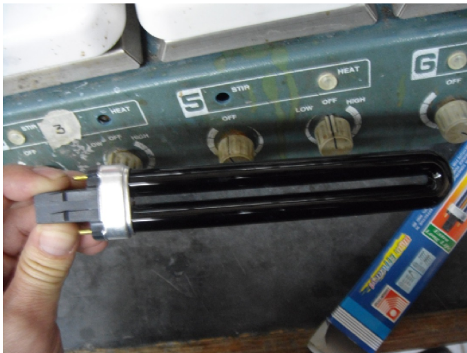
Imagen A.3.1 Lámpara morada de UV utilizada para los experimentos, potencia 9W y 12V.
