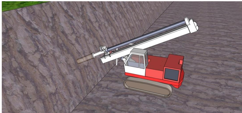
FIGURA 13 Esquematización de la perforación de un barreno
