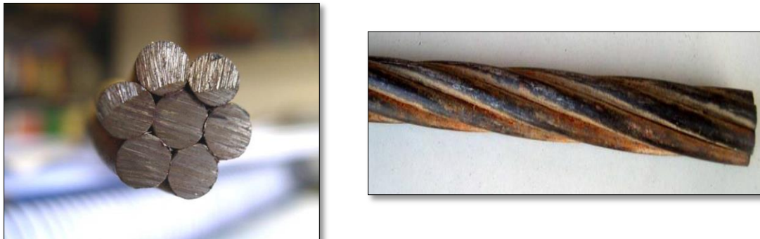
FIGURA 3 Torón de acero de 7 hilos
