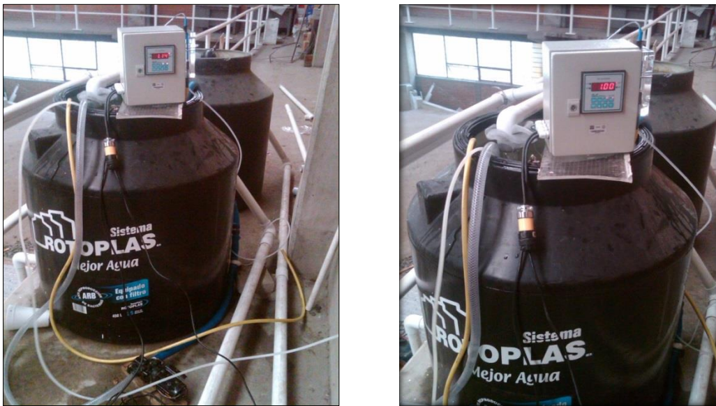
Figura 4.1. Sistema montado para estimar el coeficiente de reacción del cloro con el volumen de agua, k_b [Mompremier, 2012]
