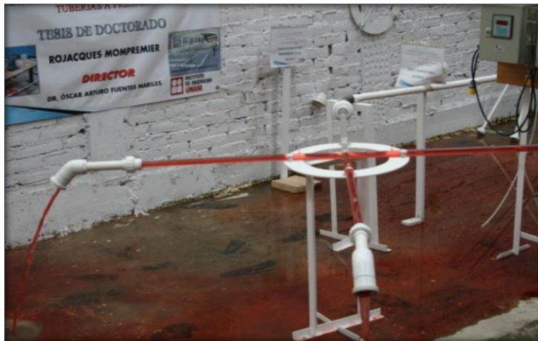
Ilustración 3.1. Mezcla parcial en cruce de tubería
