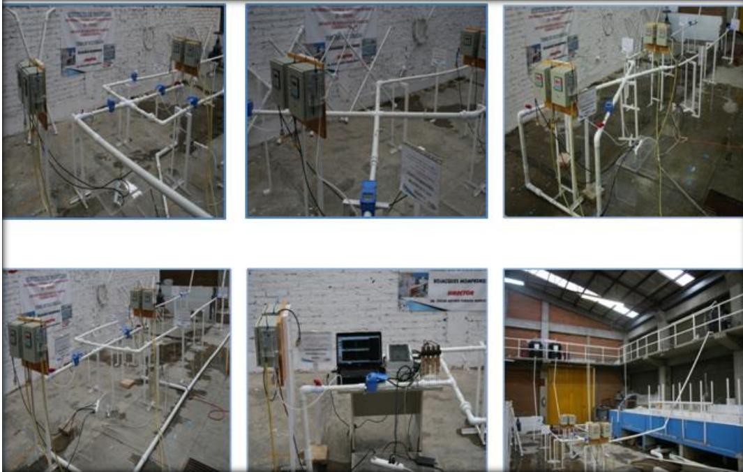
Figura 3.27. Dispositivo físico de cruces de tuberías
