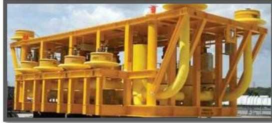
Figura 4.6 Estructura del manifold.
