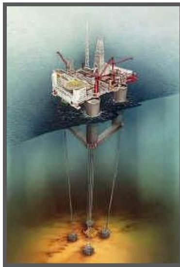
Figura 2.3 Plataforma de piernas tensionadas.
