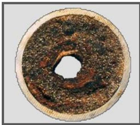
Figura 4.58 Deposición de cera en las paredes de una tubería (Phillips Petroleum Company and Dr. G. A. Mansoori).
