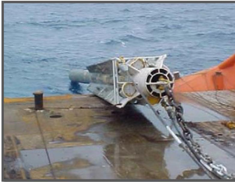
Figura 2.10 Torpedo base lanzamiento desde AHV.
