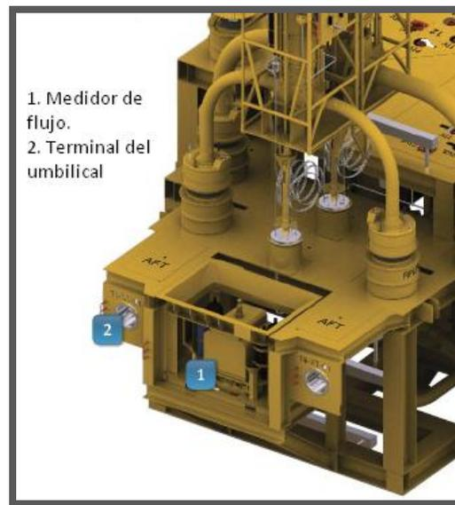
Figura 4.11 Instrumentos adicionales de un manifold.
