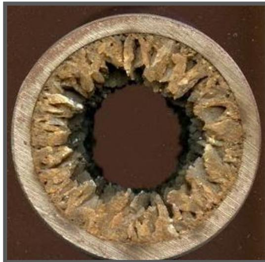
Figura 4.61 Depósito de cristales de sulfato de bario.
