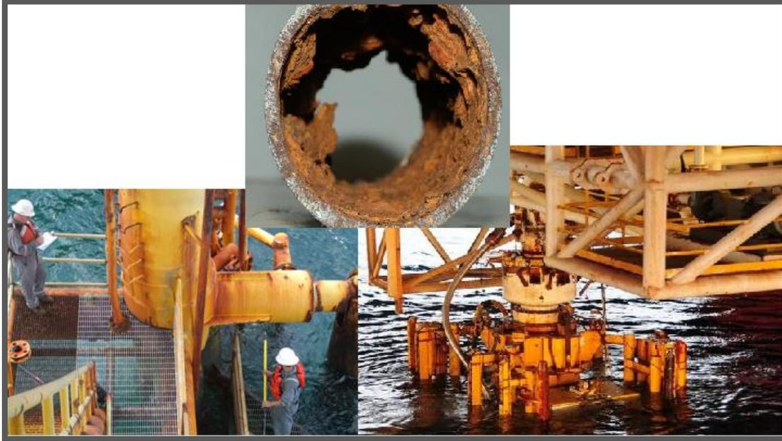
Figura 5.9 Corrosión en instalaciones superficiales, en el interior de una tubería y en el exterior de un equipo submarino.
