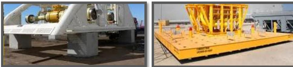
Figura 4.5 Del lado izquierdo base sobre pilotes, del lado derecho base mud mat.
