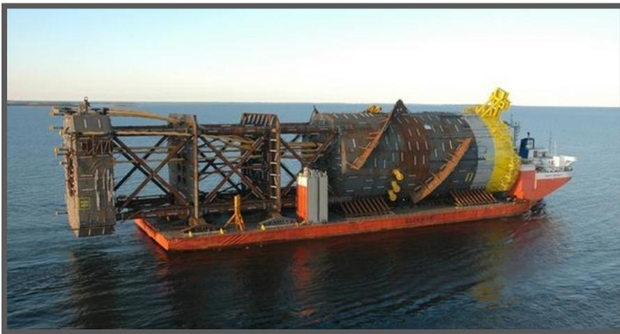
Figura 2.2 Spar, proyecto Perdido Shell.
