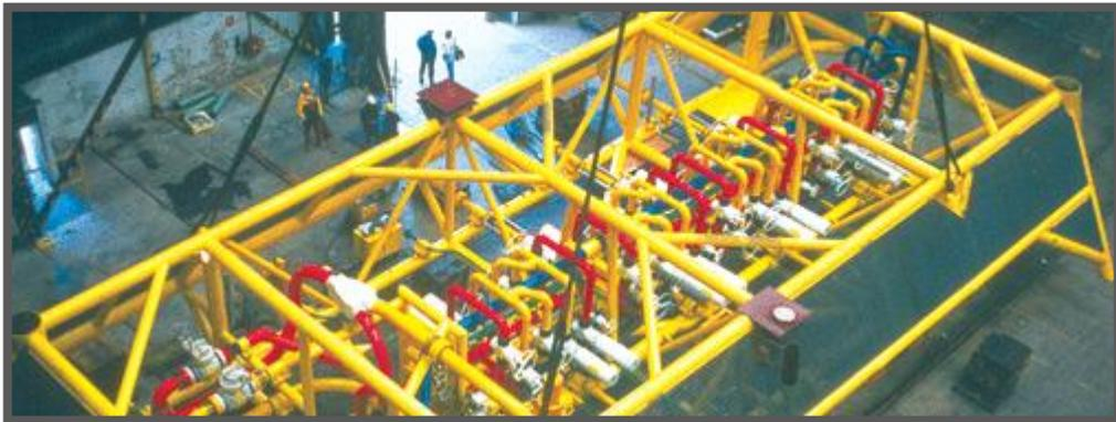
Figura 4.9 Cabezales y tuberías de un manifold.
