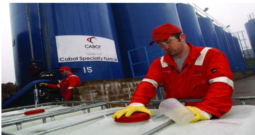
Fig. 4.10.- A diferencia del Bromuro de zinc y de calcio, las salmueras de formiato pueden ser manejadas con seguridad sin necesidad de trajes de goma, protección facial total y respiradores.
