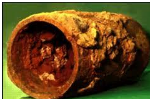
Fig. 1.7.-Efectos de la Corrosión
