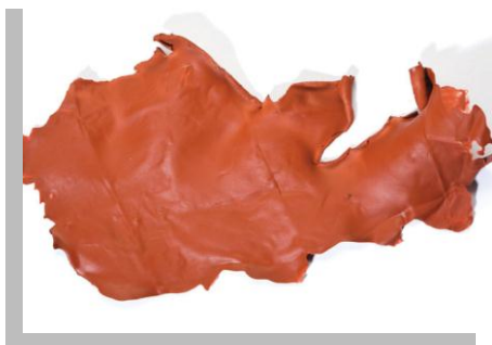
Fig. 17.- Apariencia de un impermeabilizante Elastomérico, que a diferencia de los acrílicos se presentan en tres colores, terracota, verde y blanco.
