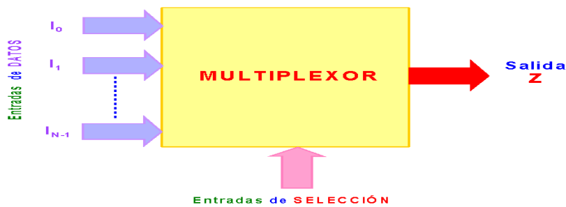
Figura 6.5 Diagrama general de un multiplexor digital
