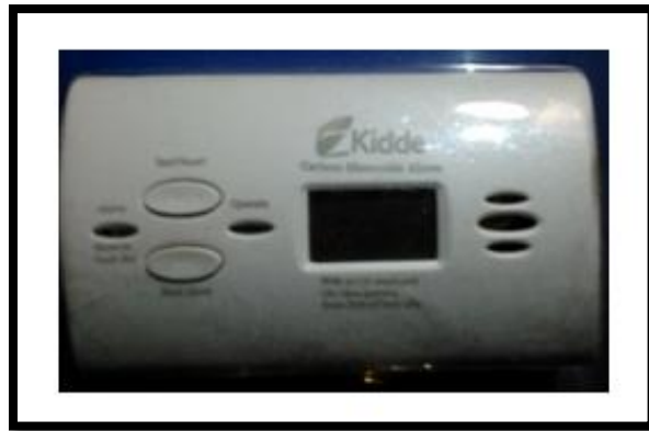
Figura 3.19 Fotografía alarma de monóxido de carbono
