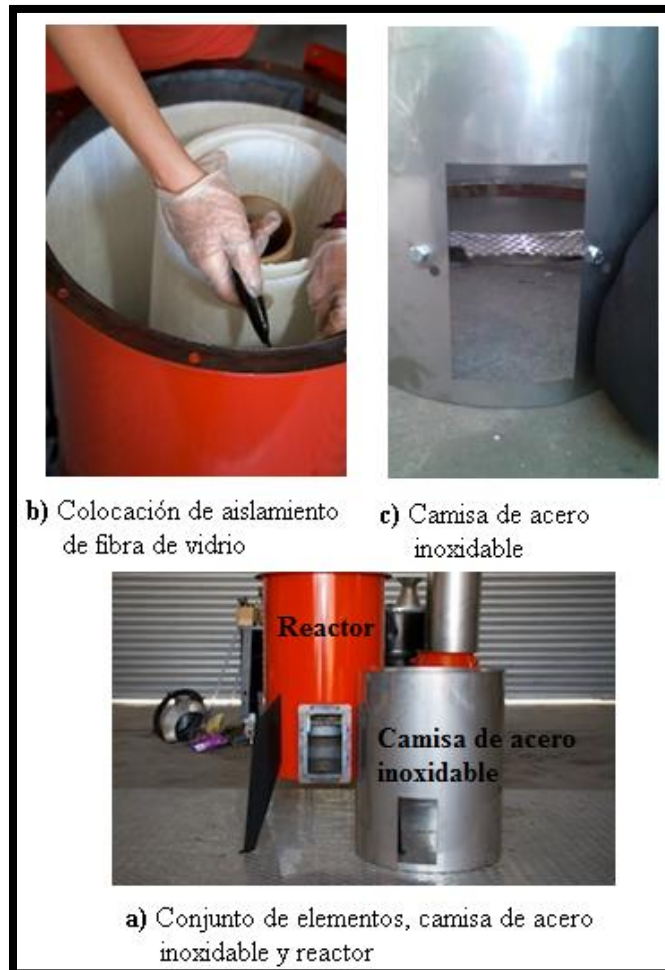
Figura 4.3 Fotografías de etapa de armado del interior de la cubierta de gas
