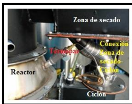
Figura 4.18 Fotografía de conexión de línea de gas
