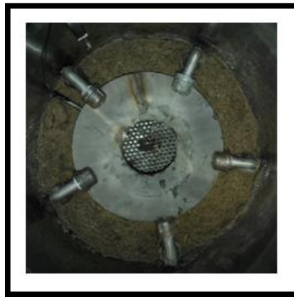
Figura 4.14 Fotografía aislamiento granular alrededor de reducción de campana
