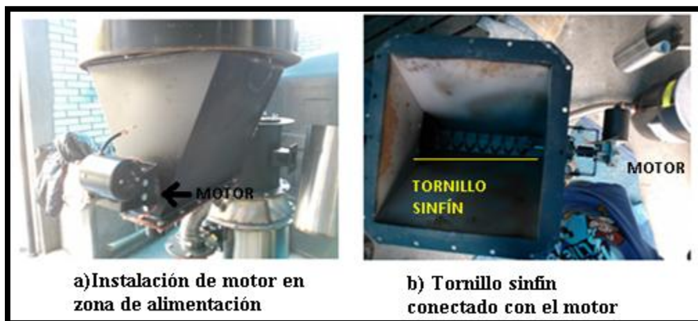
Figura 4.15 Fotografías del motor y tornillo sinfín en zona de alimentación de combustible
