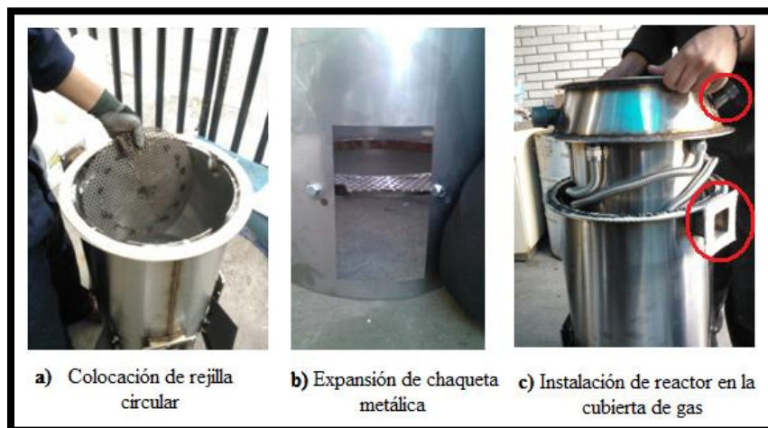
Figura 4.9 Fotografías de armado de reactor y cubierta de gas
