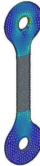
Figura 37. Esfuerzo elemental en eslabón de 3/8[in].
