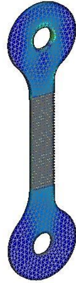
Figura 35. Esfuerzo nodal en eslabón de 3/8[in].
