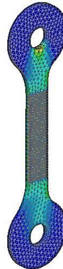
Figura 38. Esfuerzo elemental en eslabón de 1/2[in].
