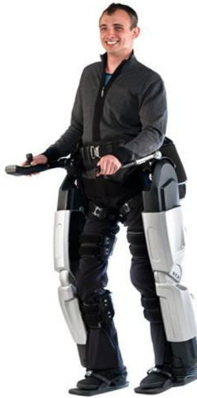
Figura 18. Exoesqueleto Rex Bionics [19].
