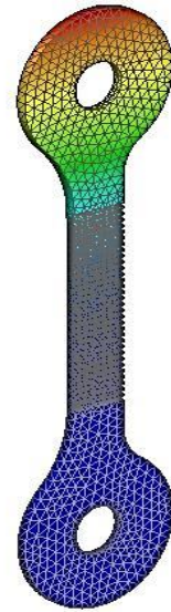
Figura 33. Desplazamiento en eslabón de 3/8[in].
