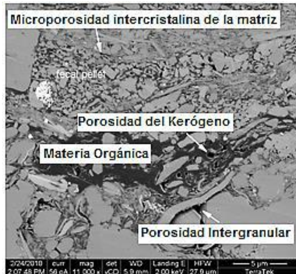
Figura 1.31 Tipos de porosidad presentes en shale gas (Modificada de Quirein et al, 2011)
