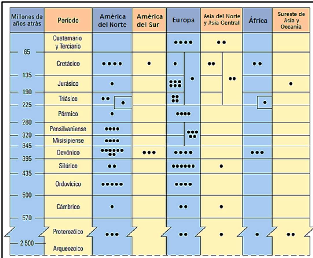
Figura 1.23 Distribución mundial de lutitas ricas en materia orgánica por período geológico. Los círculos negros representan la cantidad de ocurrencias por cada período (Modificada de Schlumberger, 2012)
