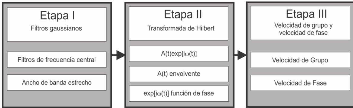
Figura 19. Diagrama de trabajo para obtener las velocidades de grupo y fase a partir de las cros correlaciones de ruido ambiental.
