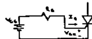
Figura 4.2.30 Método de disparo por aplicación de voltaje continuo.
