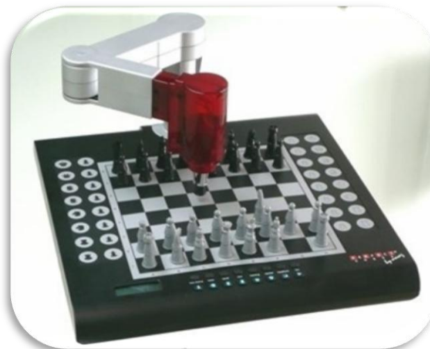
Imágen14Robot serial tipo Scara
