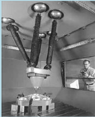
Imágen10 Centro de mecanizado Tornado de la compañíaHexel (Aracil, 2006)
