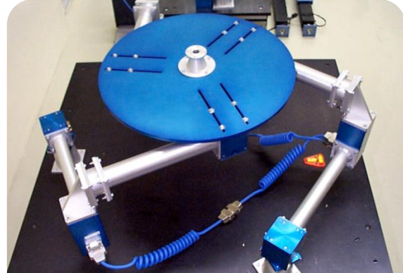
Imágen15Robot paralelo planar 3RRR (3dof)()
