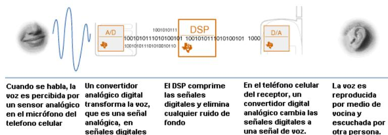
Figura 6.1: Representación gráfica del proceso de señales digitales en un teléfono celular.
