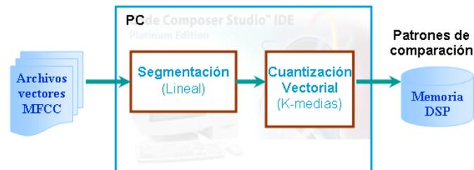
Figura 7.3: Diagrama de bloques de los procesos realizados para el entrenamiento con VQ.
