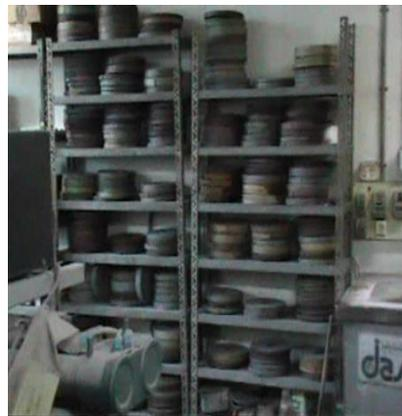
Figura 1.3. Moldes de silicón
