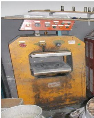
Figura 1. 2. Plancha hidráulica
