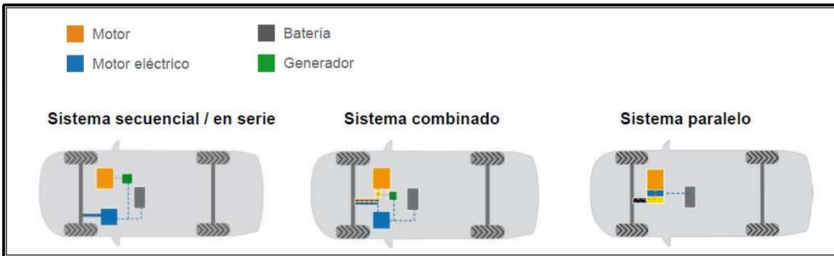
FIGURA 3 “TIPOS DE PROPULSIÓN EN VEHÍCULOS HÍBRIDOS”
