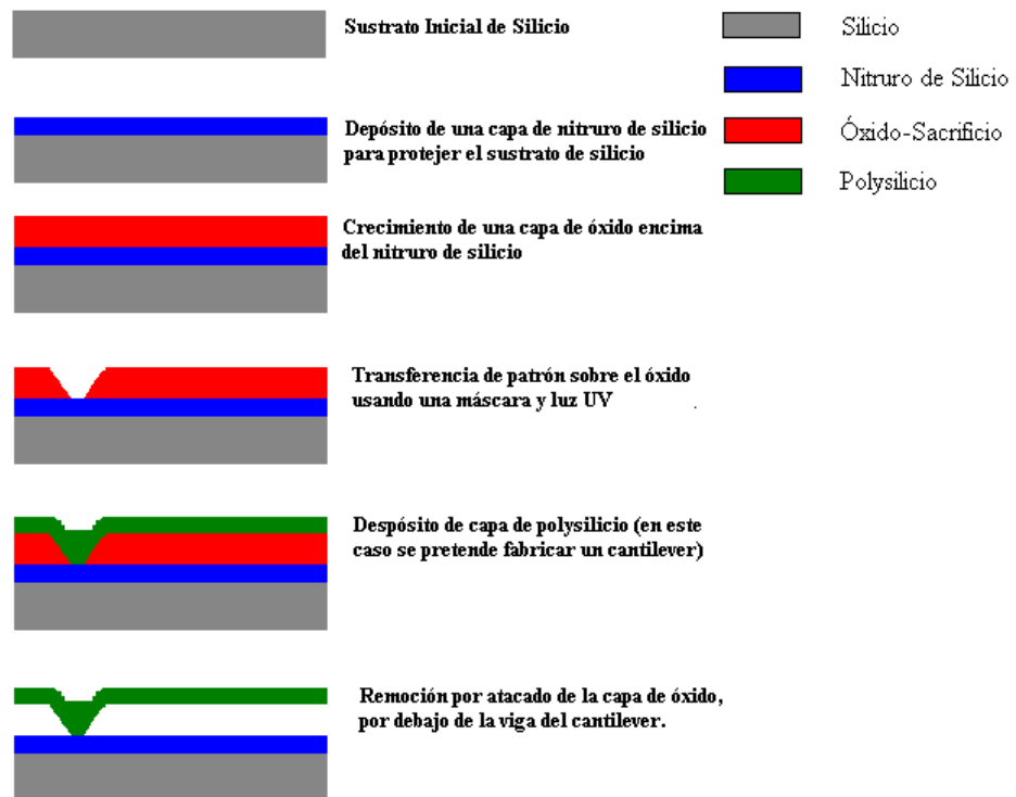
Figura 2.9 Proceso de micromaquinado de superficie para un microcantilever.
