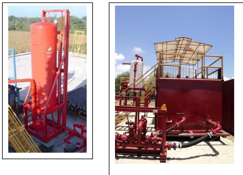
FIGURA 2.10 Sistema de separación de Fases (Cortesía Weatherford)
