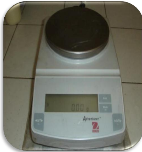
Figura 2.3. Báscula para peso de cemento y aditivos.
