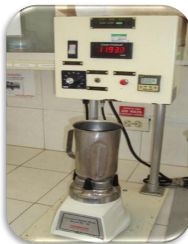
Figura 2.4. Mezclador de lechada de cemento.
