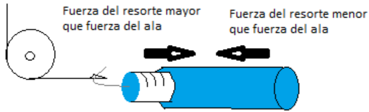
Fig. 2.2.2.1.4 Dinamómetro colocado en el extremo inferior del ala.
