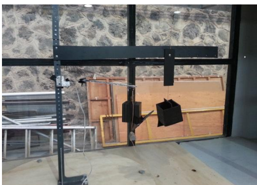
Fig. 5.3.2.8. Arreglo de Giro-Wind para la prueba de eficiencia colectiva.
