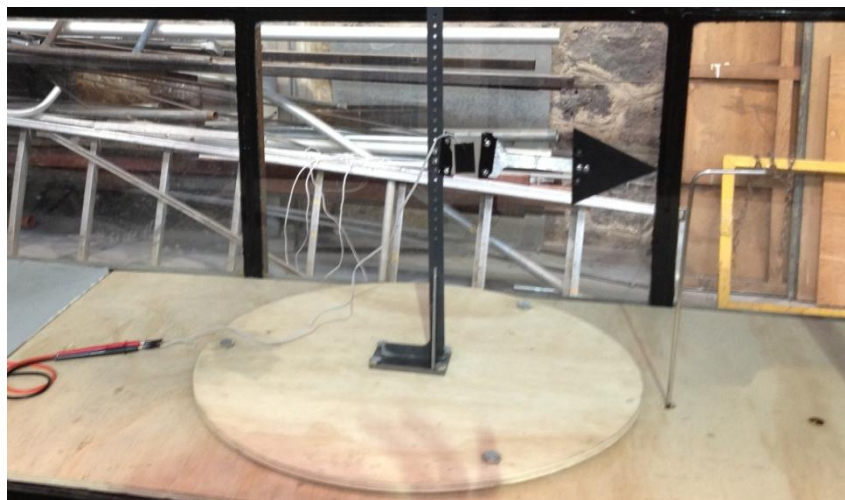
Fig. 5.2.2.1 Arreglo Piezo-Leaf en la estructura metálica para las pruebas en el túnel de viento.
