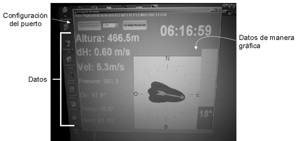
Figura 3.69.: Estructura de la pantalla de despliegue
