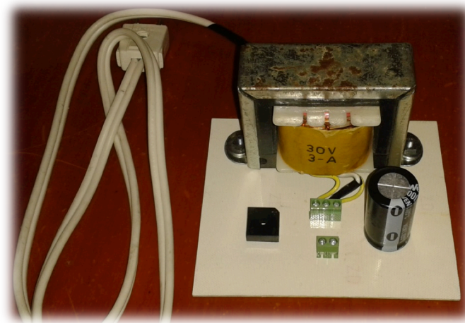
Figura 4.17 PCB fuente 40 VCD 4 A
