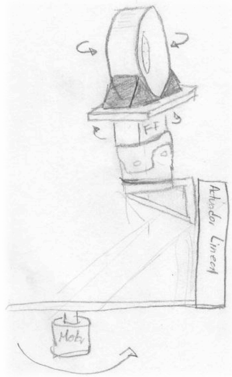
Figura 3.3 Movimientos de la llanta (actuador)
