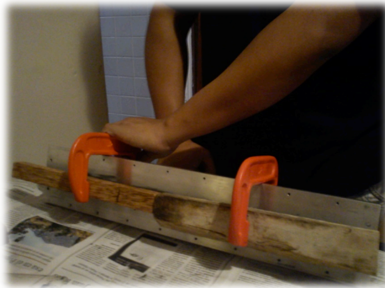
Figura 4.11 Fijación del tren de ferritas
