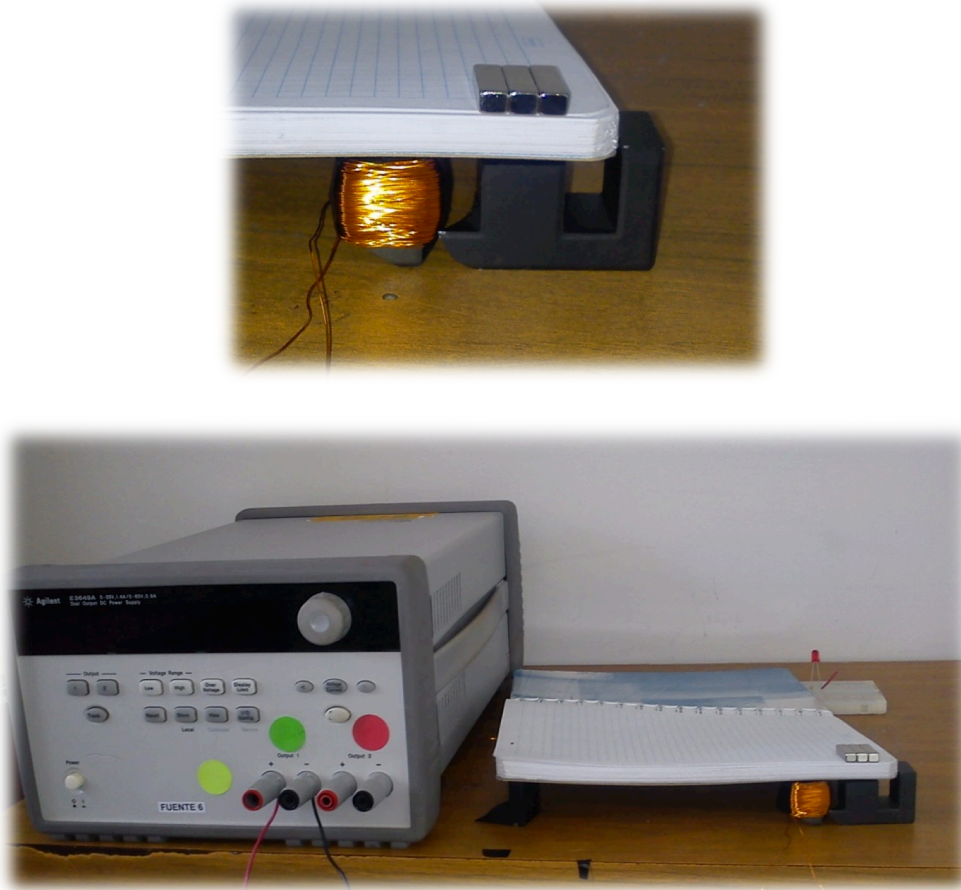
Figura 3.25 Bobina con imanes (superior); Prueba con fuente (inferior)
