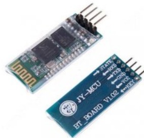
Figura 3.34 Módulo de Bluetooth Hc-05
