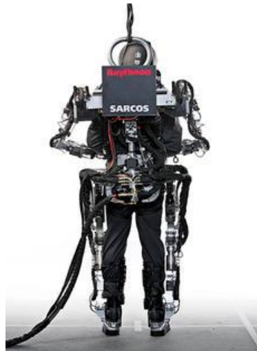
Figura 1.5. Computadora y sistemas de control del Sarcos XOS (Dollar & Herr, 2008)
