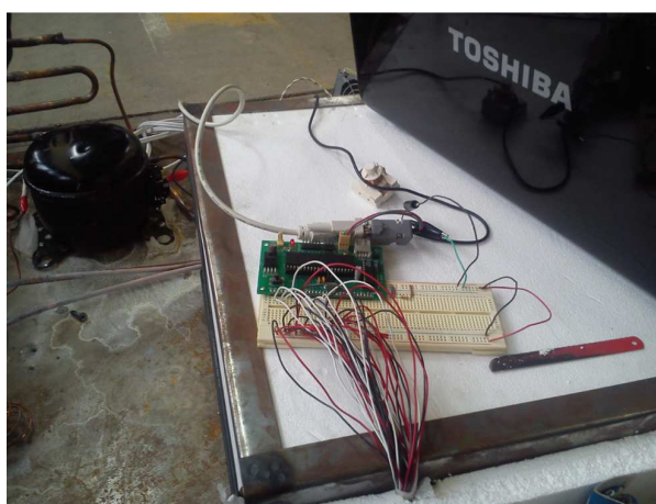
Figura 37 Circuito para conocer la distribución de temperatura.
