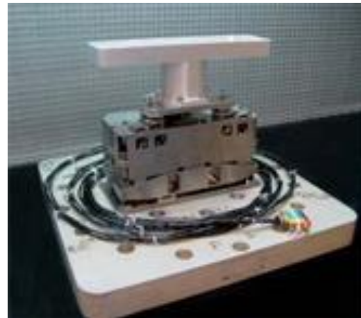
Figura 7 Dispositivo de alineación para GAIA M2M [3]
