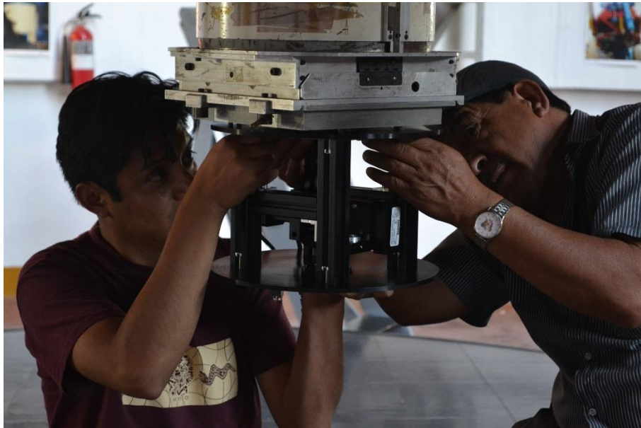
Figura 55 Integración de la estructura de Berkut con la platina del telescopio.
