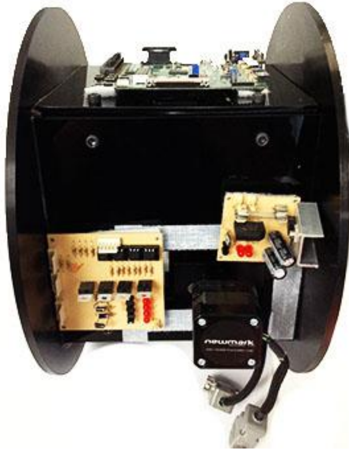
Figura 50 Berkut ensamblado con las tarjetas electrónicas.
