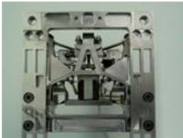
Figura 7 Dispositivo de alineación para GAIA M2M [3]
