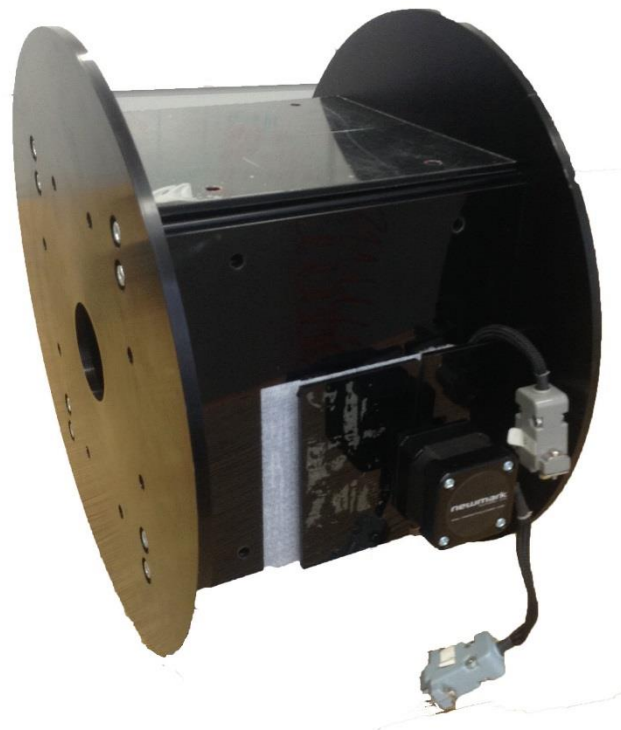
Figura 49 Berkut ensamblado con cubiertas antirreflejante.
