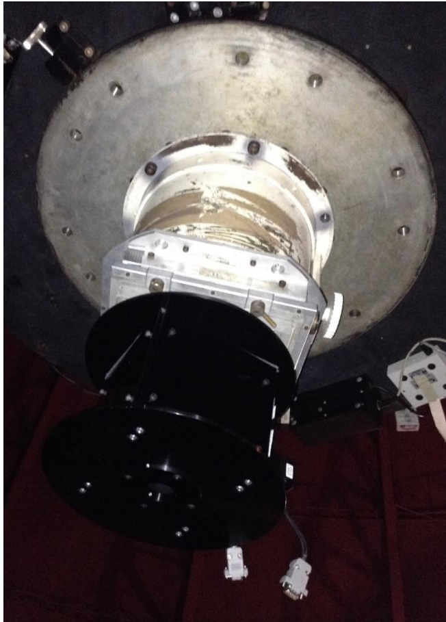
Figura 56 Berkut integrado a la platina del telescopio mediante una extensión.
