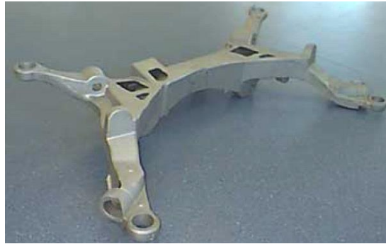
Figura 2-19: Sub-chasis trasero fabricado en una sola pieza con tecnología VRC/PRC Vacuum riserless Casting / Pressure Riserless Casting en 1998
