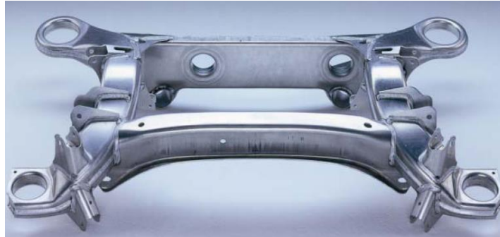
Figura 2-23: Sub-chasis Mercedes clase S (Peso 12.5 kg)
