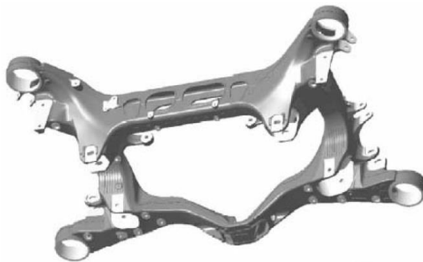
Figura 2-20: Sub-chasis en marco Porsche Panamera fundición en aluminio.
