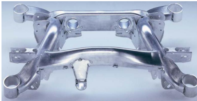
Figura 2-22: Sub-chasis con partes de aluminio rolado e hidroformado Fuente: Hydro Aluminium Rolled Products
