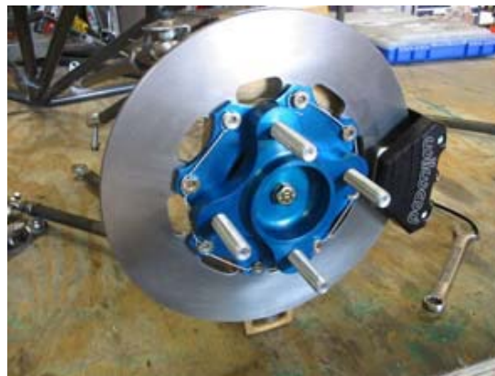
Figura 3.18, Masa delantera de un vehículo prototipo todo terreno.
