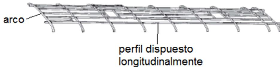
*Figura 1. 4 Estructura del panel del techo.*
