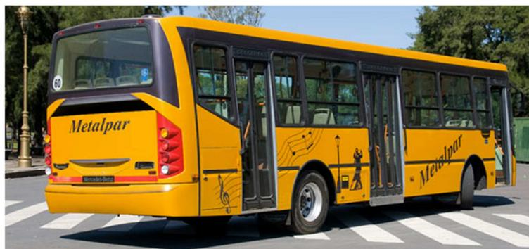
**Figura 3. 7** Ejemplo de diseño de carrocería de piso bajo para chasis OH 1618 L-SB.
