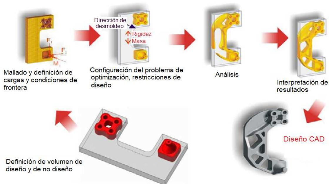
**Figura 2. 1** Diseño de una pieza mediante optimización estructural topológica (Altair Engineering, *Practical Aspects of Finite Element Simulation: A Student Guide*, 2012).
