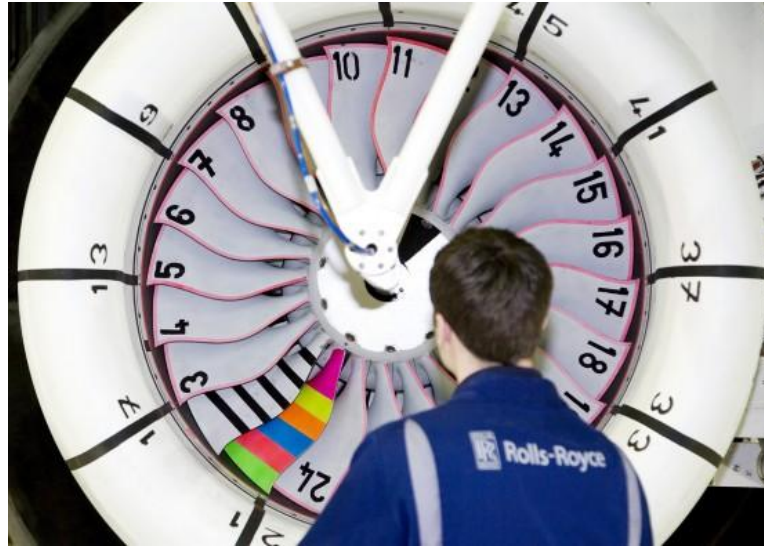
Figura 2.4: Preparación del abanico delantero del motor para la prueba de pérdida de un álabe, cortesía de Rolls Royce Limited Co. 38
