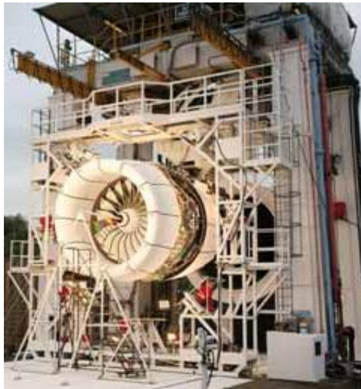
Figura 2.3: Prueba de pérdida de un álabe en una turbina de Avión, cortesía de Rolls Royce Limited Co. 38
