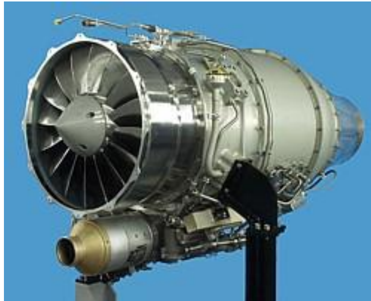
Figura 2.1: Motor con dispositivo de sujeción actualmente usado en la celda de pruebas para realizar la prueba de pérdida de un álabe 35 .
