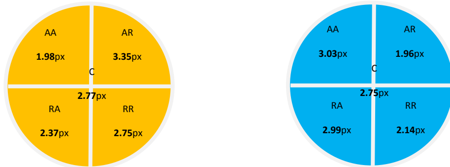
Fig. 6.5. Valores en pixeles logrados en las diferentes zonas con el mecanismo de alineación y enfoque, en las pruebas preliminares (Columna 1: 2 mm; Columna 2: 3 mm y columna 3: 0.25 mm) y en las finales (todas las columnas a 0.67mm).
