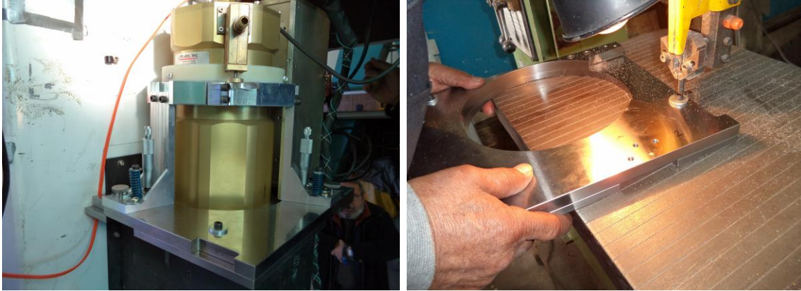
Fig. 4.3. Modificaciones de mejora en la abrazadera y en las placas.
