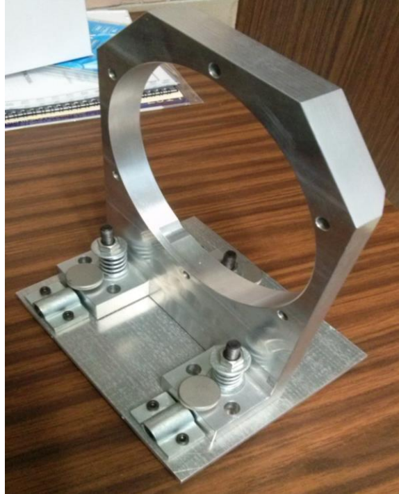
Fig. 3.5. Prototipo de función crítica para el tip-tilt y los movimientos de los topes.
