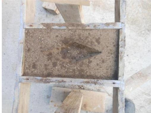
**Figura 90.- Cavidad de la rejilla de moldeo, cuando se ha compactado con el apisonador.**
