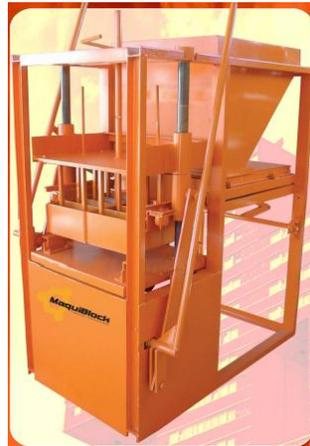
**Figura 16.- Máquina vibrocompresora de origen nacional marca maquiblock.**
