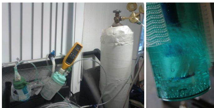
Figura 42. Sistema de humectación de argón.
