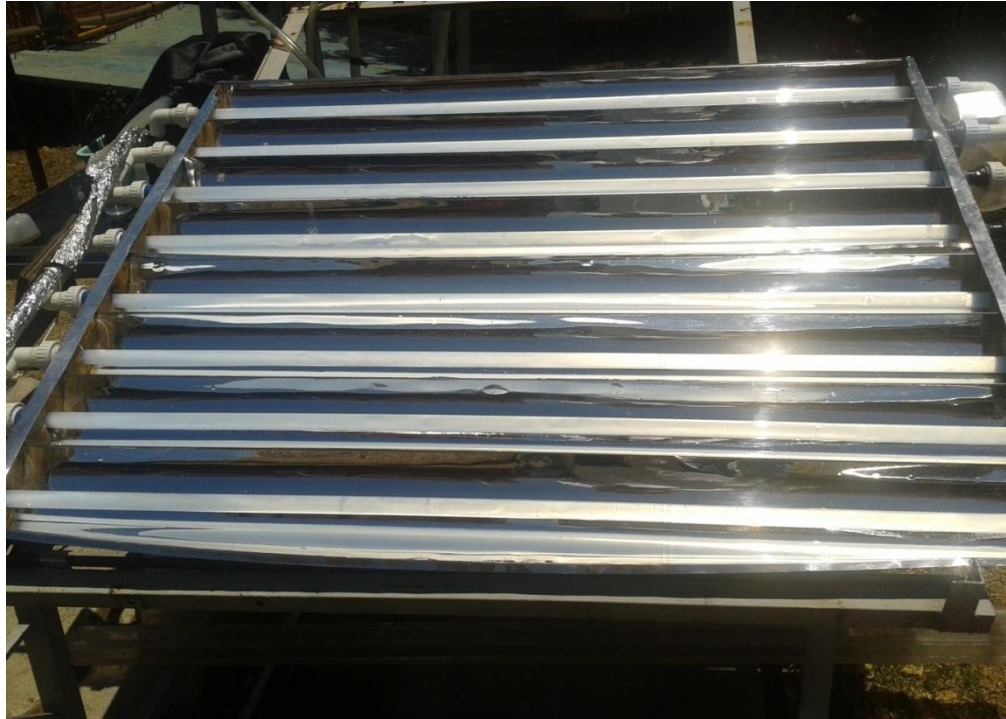
Figura 21. Colector Parabólico Compuesto de la Planta Solar del Instituto de Ingeniería de la UNAM utilizado para realizar experimentos de fotocátalisis solar.
