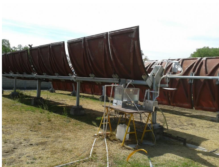
Figura 64. Vista posterior del sistema de reacción del CCP.
