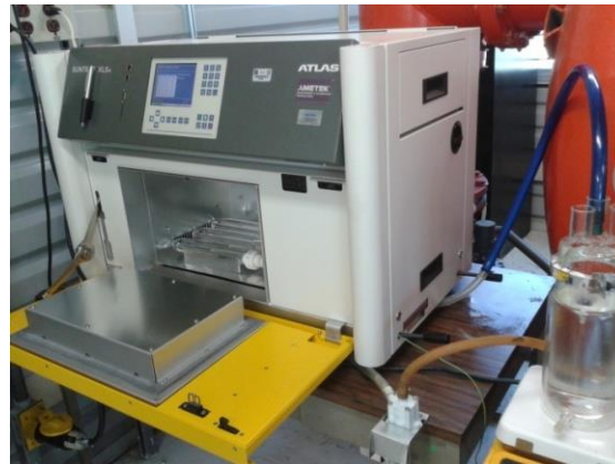
Figura 29. Sistema utilizado para realizar la fotólisis.
