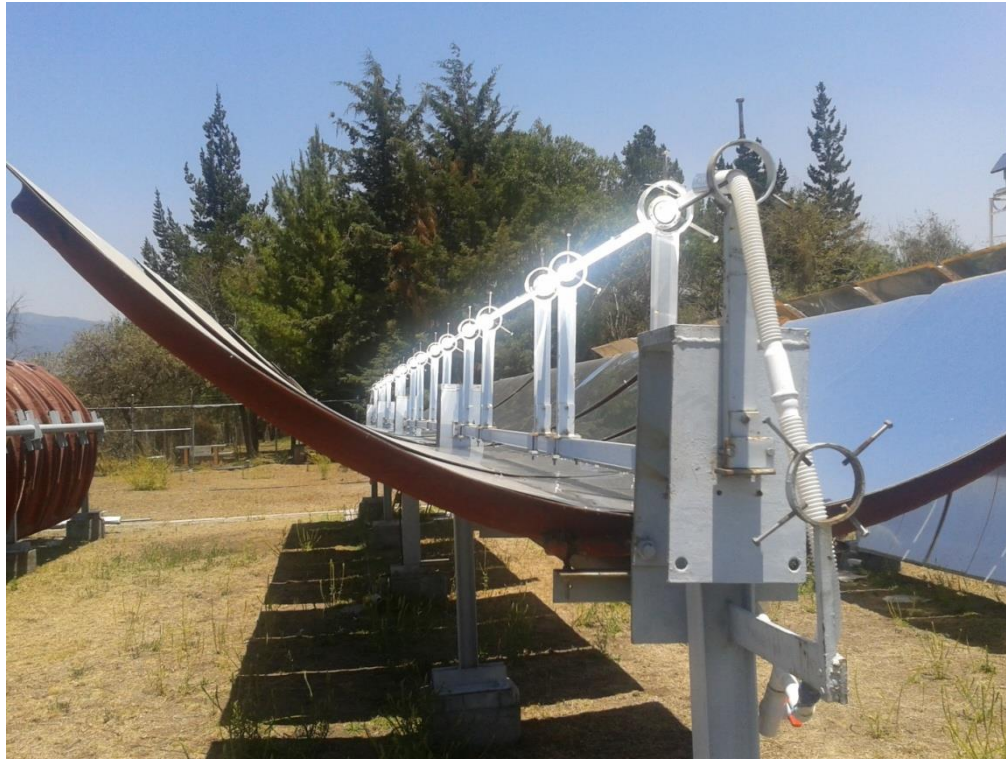
Figura 17. Concentrador de Canal Parabólico de la Planta Solar del Instituto de Ingeniería de la UNAM utilizado para realizar experimentos de fotocátalisis solar.
