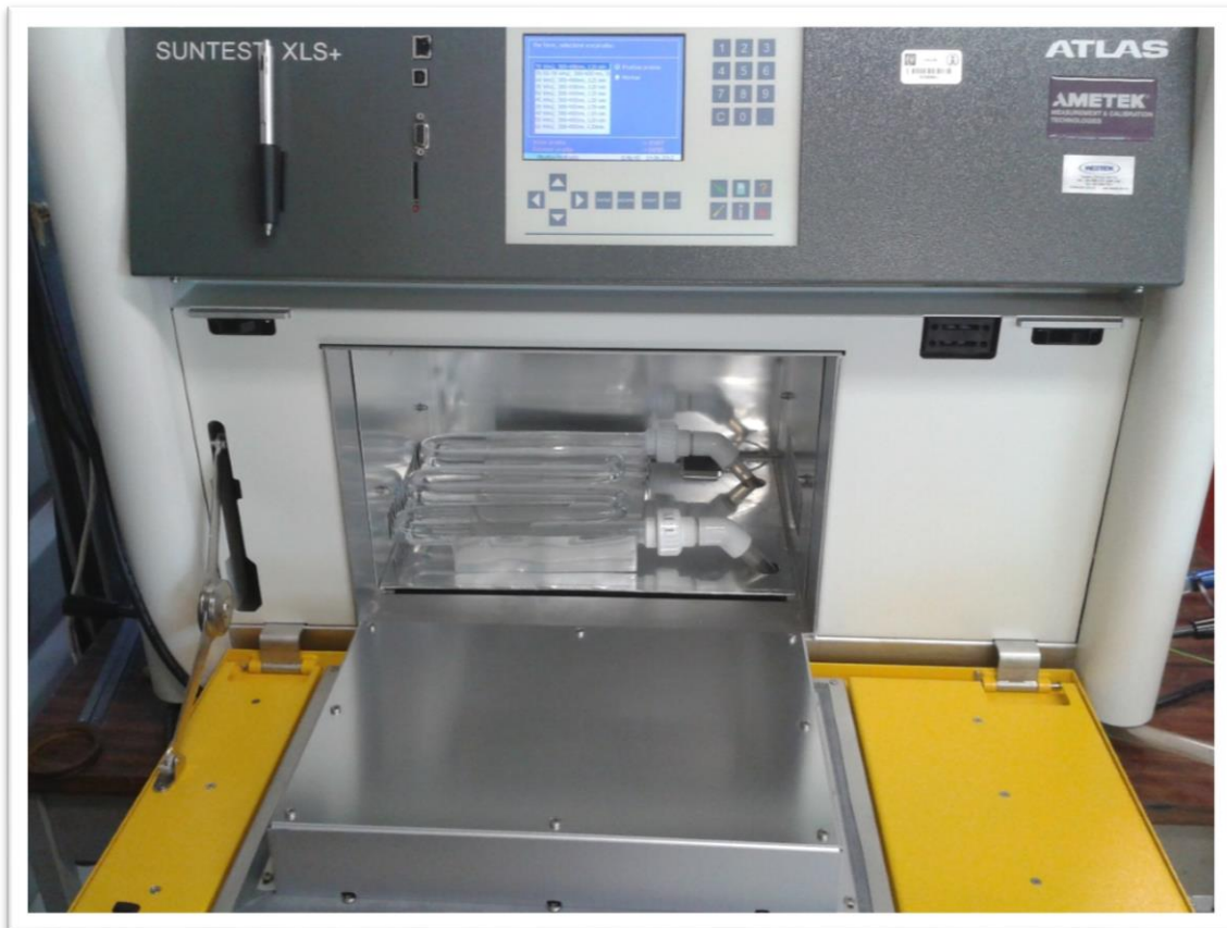
Figura 31. SolarBox con el foto-reactor en su interior.
