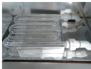
Figura 57. Foto-reactor utilizado en los experimentos.
