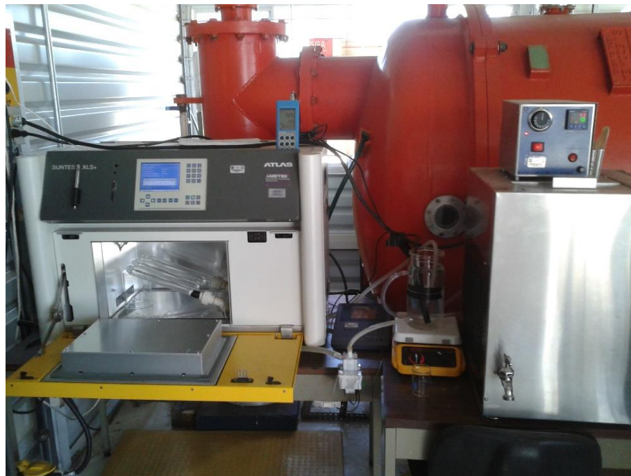
Figura 63. Sistema utilizado para las pruebas en la SolarBox.
